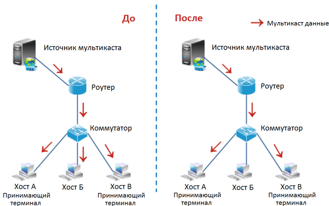
До/после включения коммутатором функции IGMP snooping
